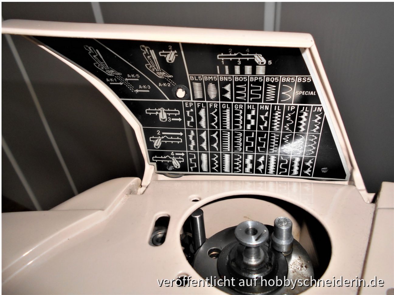
Einlegefach für Stichschablonen, Stichtabelle in der Abdeckung. Foto: Sporcherin
