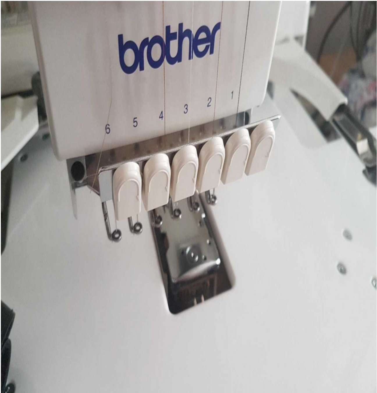
brother PR-600 Stickarm, unten Greiferabdeckung/Greifer
