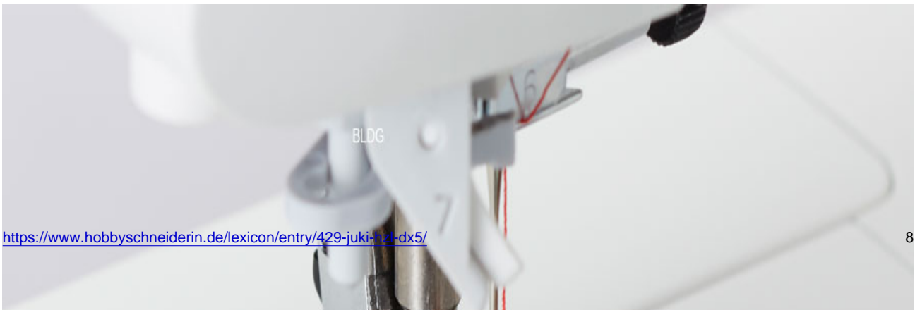
JUKI HZL-DX5 automatischer Nadeinfädler
